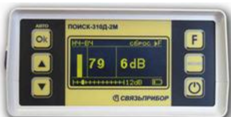
бесконтактные двухчастотные методы поиска повреждения изоляции кабеля
