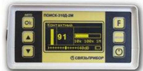
контактный поиск повреждения изоляции кабеля
