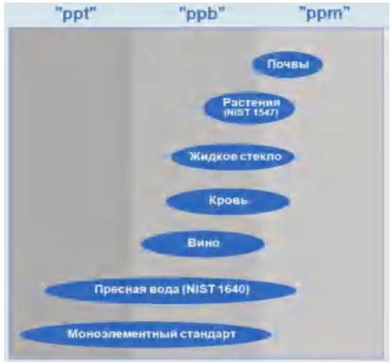
Рис. 3: Значения нижнего предела обнаружения для различных образцов, проанализированных с помощью спектрометра S2 PICOFOX
