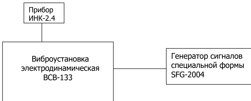
Рисунок 4 – Схема измерения амплитуды виброперемещения
