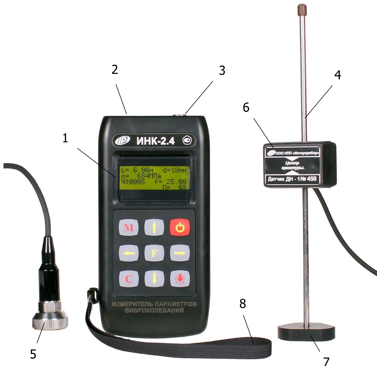
Рисунок 1 – Общий вид прибора модификации ИНК-2.4К
